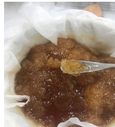
รูปที่ 3 เพคตินที่สกัดได้จากเปลือกกาแฟก่อนการอบให้แห้ง
