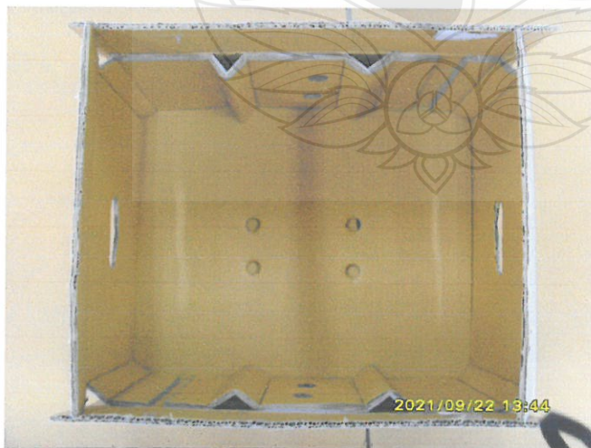
ภาพที่ 14 กล่องแบบ Wrap around เพิ่มพื้นที่มุมทั้ง 4 มุมและคอลิ้น 4 คอลิ้น (WC8)
