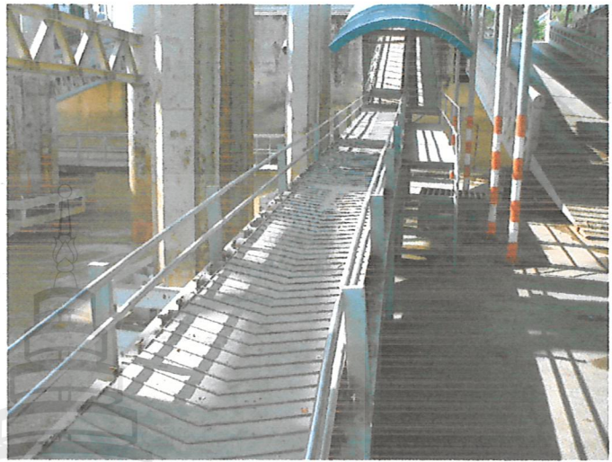
ภาพที่ 17 สายพานลำเลียง เพื่อใช้ขนถ่ายสินค้า ณ ท่าเรือเชียงแสน
