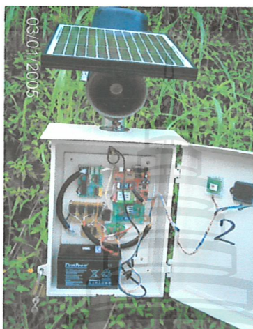
ภาพที่ 4-14 ต้นแบบอุปกรณ์ตรวจวัดปริมาณน้ำฝน
