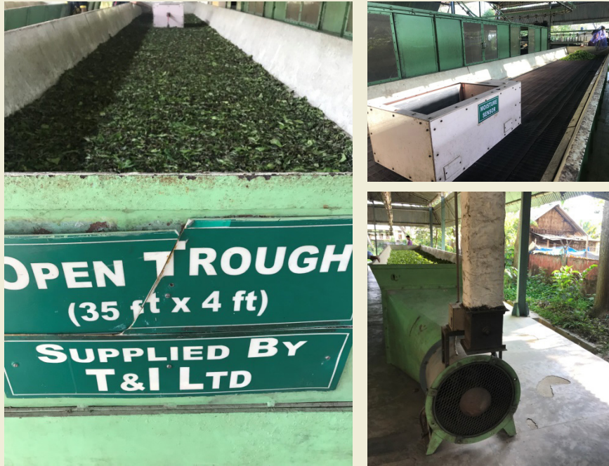
ภาพที่ 2 กระบะผึ่งใบชา ที่มีเซนเซอร์เพื่อควบคุมปริมาณความชื้นในระหว่างการผึ่งชา
