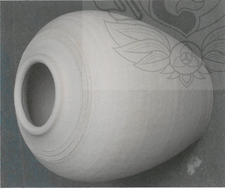
ตัวอย่างผลิตภัณฑ์ซึ่งมีรูปร่างคล้ายแจกัน โดยใช้ดินจาก 3 แหล่ง ในตำบลเวียงกาหลง (ซ้าย) ดิน BHC (กลาง) ดิน BRC ผ่านเพียงการเผาปกติและไม่เคลือบ (ขวา) ดิน BTC ผสมกับดินขาว 20 เปอร์เซ็นต์โดยมวล เคลือบและเผาครั้งที่ 1250 องศาเซลเซียส
